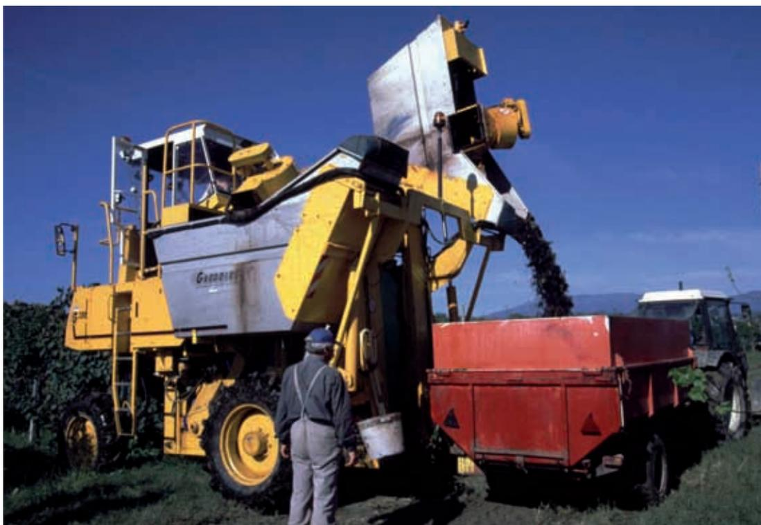
Foto 2. Vendemmiatrice semovente in fase di scarico dell'uva (foto dell'autore)
